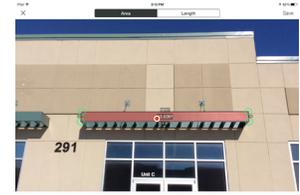
✅ Das Vordach befindet sich auf der gleichen Ebene, auf die der Laser gerichtet wurde (roter Punkt). Die Messungen fallen somit genauer aus.
